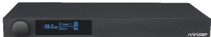
Der miniDSP SHD ist eine sehr leistungsfähige DSP-Vorstufe mit Dirac-Filtern
