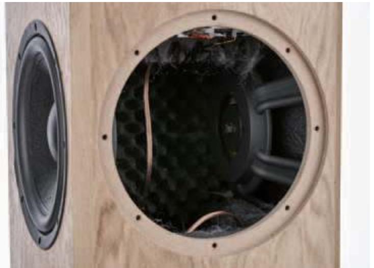
Innenansicht der BB-10 ohne Tief/Mitteltöner: Man erkennt im oberen Bereich den teilweise sichtbaren Bändchenübertrager und jeweils seitlich die passiven Sica-Chassis
