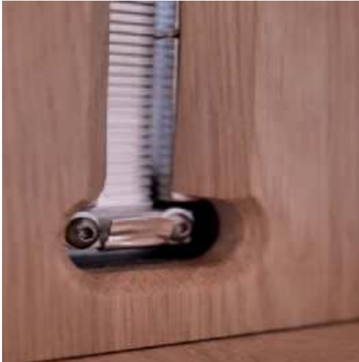
Rückansicht des Bändchentreibers, wie er in der aufgesetzten Holzplatte sitzt – man sieht die strukturierte Membranoberfläche
