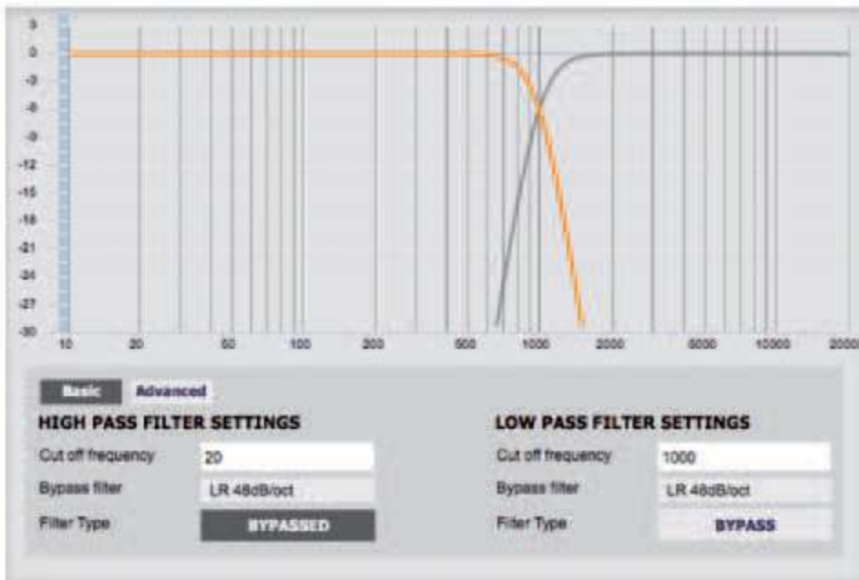
Parametrische EQs und Crossover-Settings für den Aufbau der virtuellen Weiche im DSP-Backend-Bereich
