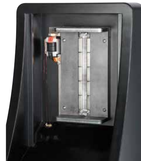
Das patentierte Bändchen mit Übertrager läuft bis 1000 Hertz hinunter und arbeitet als Dipol, strahlt also auch nach hinten ab.
