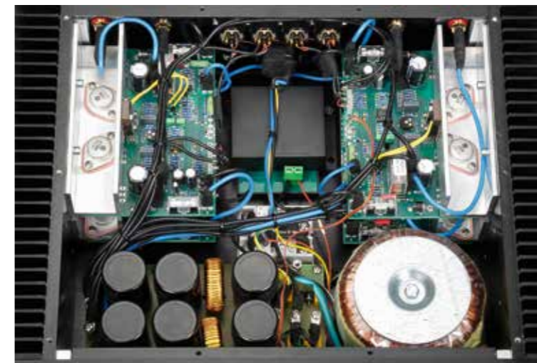
Die Endstufe beherbergt einen Trafo mit 500 VA, Elkos mit 60.000 uF Siebkapazität und vier Verstärkerzüge mit rund 600 Watt Gesamt-Sinusleistung.
