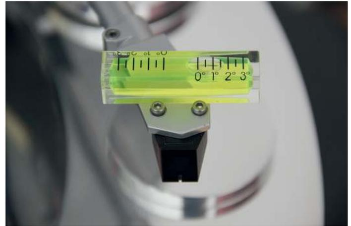
Bild 6: Abweichung der Wasserwaage um 1,5°
