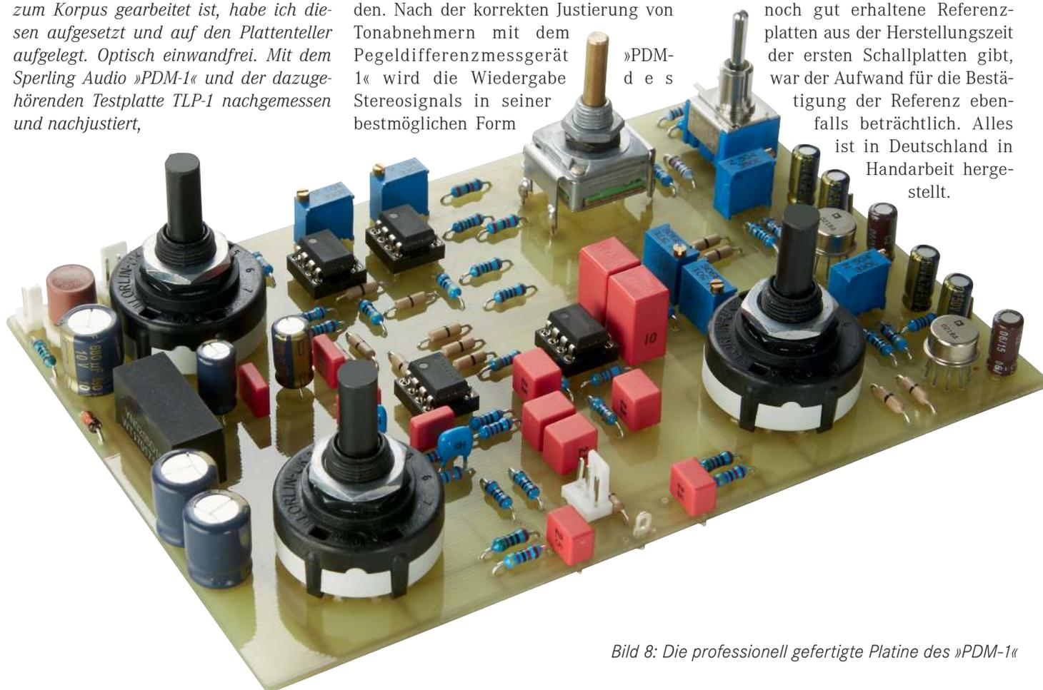
Bild 8: Die professionell gefertigte Platine des »PDM-1«
