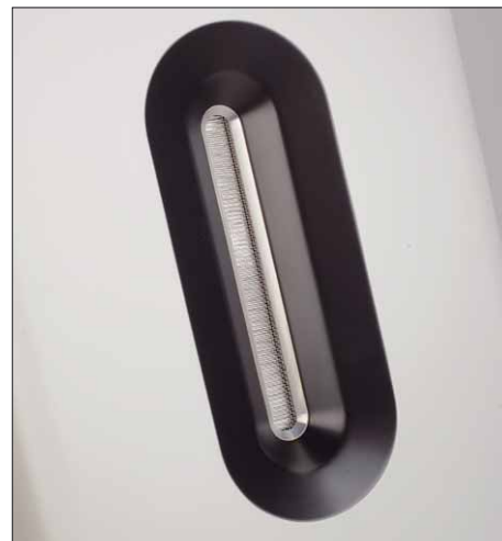
Der Bändchenhochtöner aus eigener Fertigung ist zur Vergrößerung der schallabstrahlenden Fläche vielfach gefaltet und sitzt in einem kurzen Waveguide
