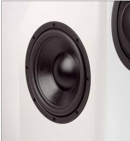
Die Passivmembranen haben mit ihrer weichen Aufhängung eine sehr tiefe Resonanzfrequenz, was mit der elektronischen Bassanhebung zu einer Grenzfrequenz um die 25 Hertz führt
