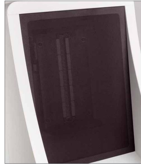
Durch den Bespannstoff sieht man die kräftigen Neodom-Magneten des Bändchenhochtöners, der als Dipol auch nach hinten abstrahlt
